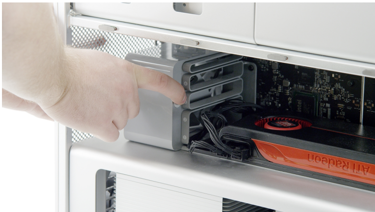
Figure: Slide PCIe Fan Away
